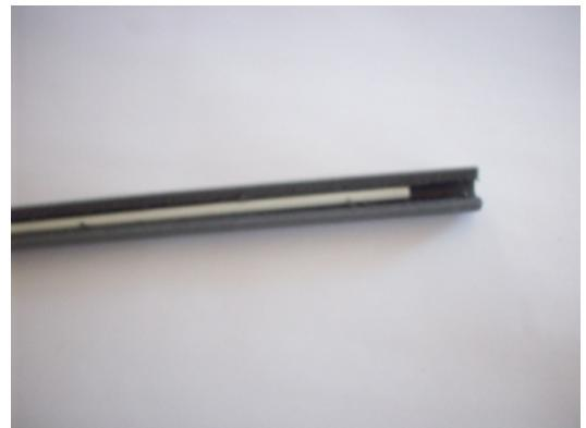
8° Collez les bords en mousse en remontant petit à petit jusqu'à l'autre extrémité. Rq : La mousse sera plus longue que le tube de fibre d'un cm ; si c'est plus, coupez-
