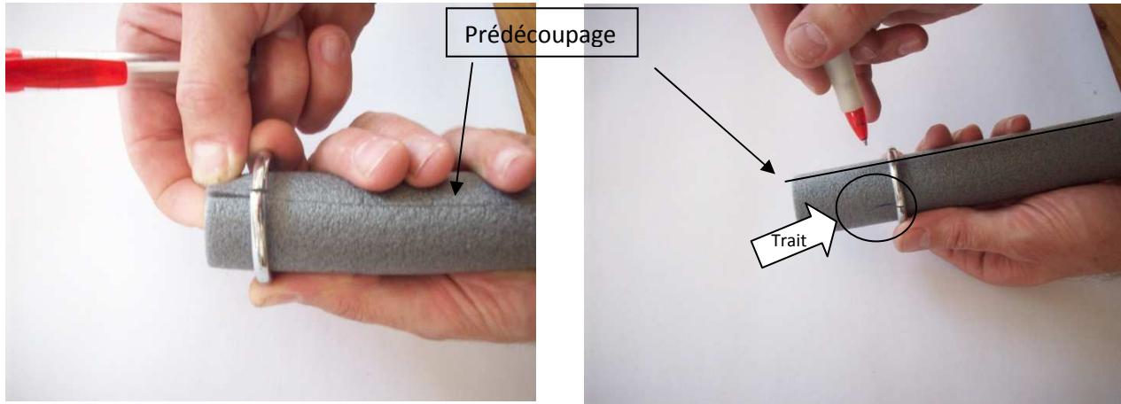
3° Placez la mousse entre la porte et le montant de porte. Fermez doucement la porte pour maintenir en pression (pas trop fort) le tracé au stylo côté montant.
